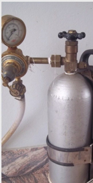
Figura 1: Pulverizador costal pressurizado de CO 2 com manômetro.
