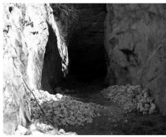
Figura 6: feldspato acumulado na entrada do garimpo. Fonte: acervo CEDGEM.
